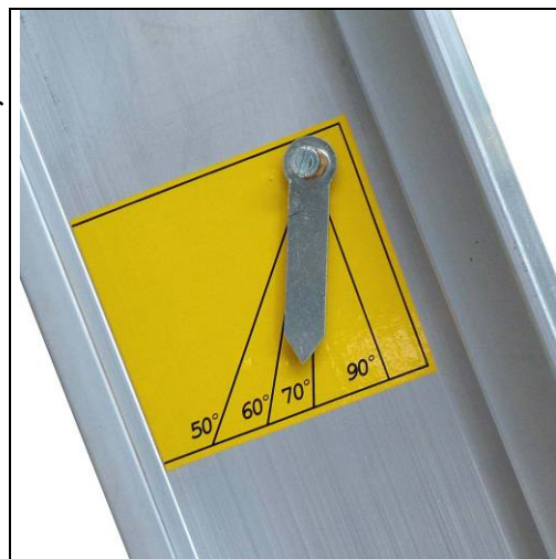
Fig. 26 Schaal voor de hellingshoek
